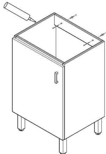
Fixer le panneau arrière au mur avec des vis et étalez l'émulsion sur le haut du petit placard.
